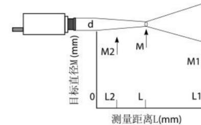
注：d=20mm 表示測溫儀口徑，L 表示測溫儀標定時的距離，M 表示測溫儀標定時的光斑尺寸。
