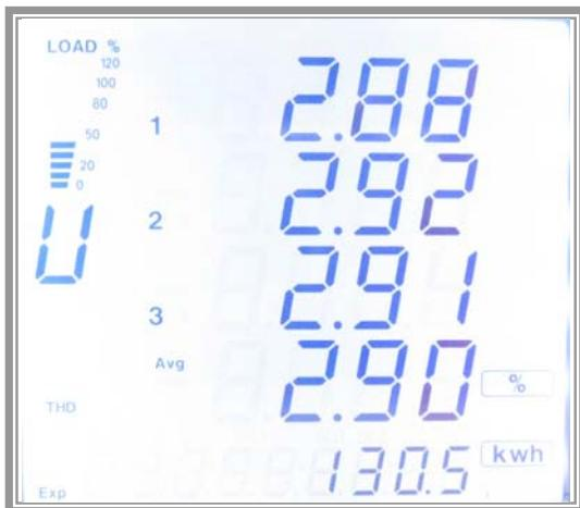
電壓(3P4W)諧波失真率顯示畫面
