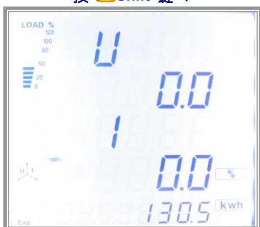
電壓及電流不平衡度顯示畫面
