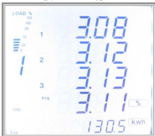
電流(3P4W)總諧波失真率顯示畫面
