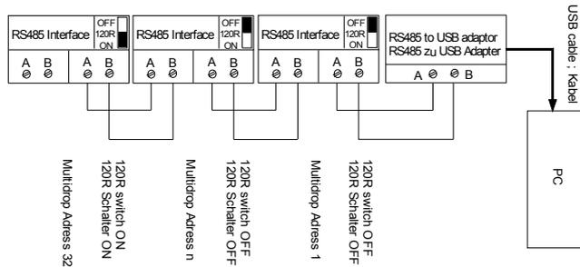
**Fig. 10.4: Correct wiring**
