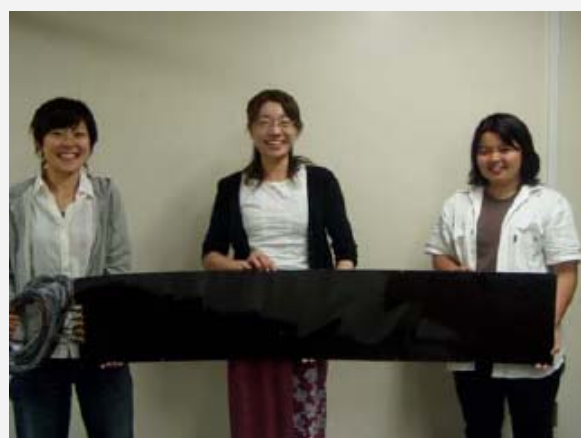
图 4：巨大的超薄热流传感器 （厚度：0.4 mm）
