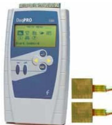
高性能、超薄 HFS 50 熱流感測器，有效抵禦環境（如風速、溫度）變化的影響，且在較小的室內外溫差下即可進行高精度測量
