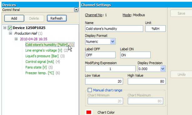
Figure 2.7. Channel parameters
